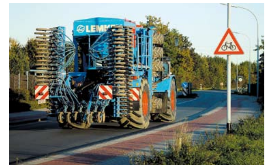
De 6 m brede Lemken Brilliant is binnen twee minuten klaar voor wegtransport.
