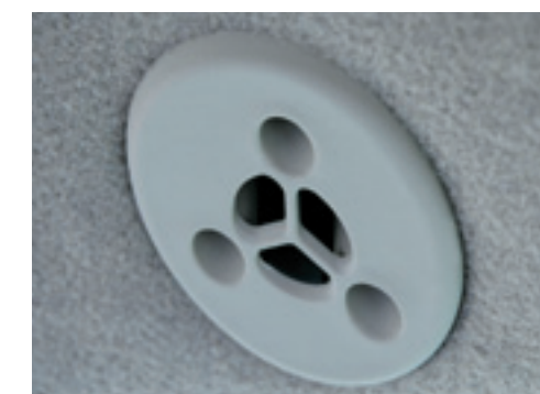
Twee openingen in het dak van de cabine, achter de bestuurder moeten tonen lager dan 100 Hertz dempen.
