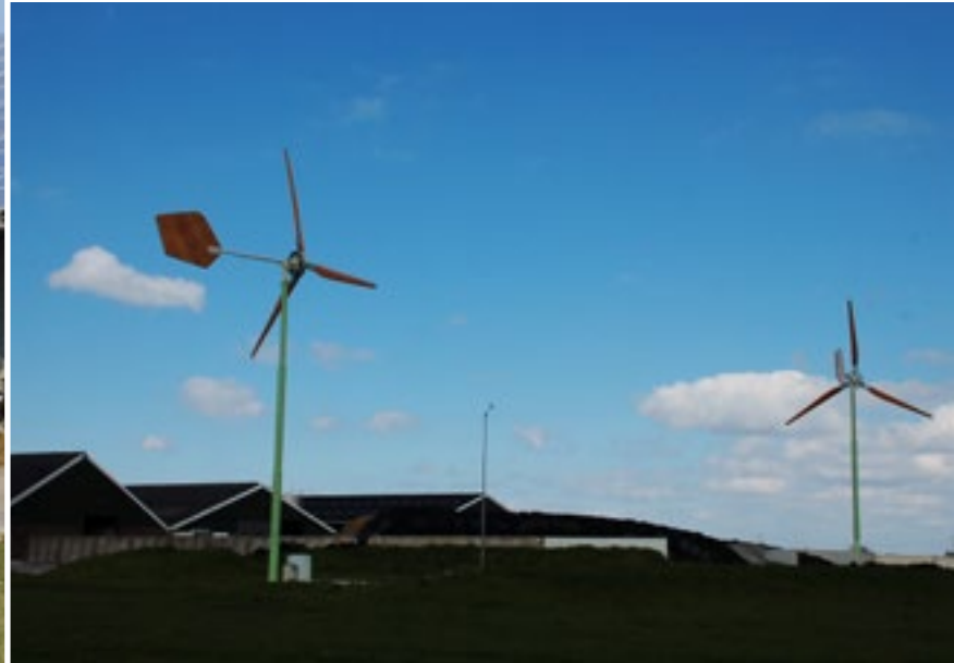
De EAZ 12-windmolen die Veehouderij Techniek in 2017 doorrekende, is intussen vervangen door de EAZ 13.2 met een rotordiameter van 13,20 meter.
